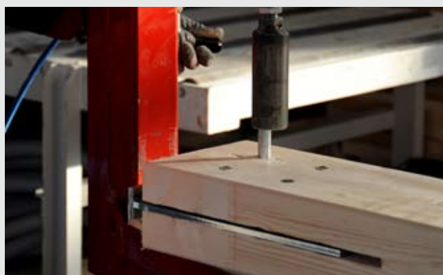
3.2 Montaggio piastra Spinotto con perni
